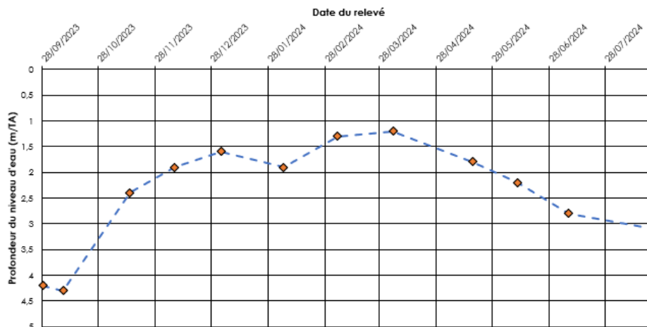
Relevé piézométrique SP2+Pz (09/2023 au 09/2024) – Réf. 23/02162/BORDX
